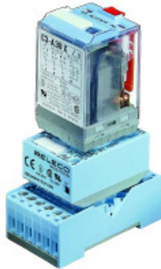
Los módulos **CT2** y **CT3** son temporizadores electrónicos diseñados para ser insertados entre un relé octal o undecal y su base de enchufe, permitiendo que el relé opere como temporizador.
