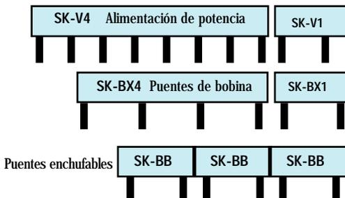
El dibujo muestra un ejemplo de montaje con dos posibles sistemas de conexión del terminal común de la bobina, por medio de los puentes SK-BB o por puentes externos SK-BX4 y SK-BX1.
